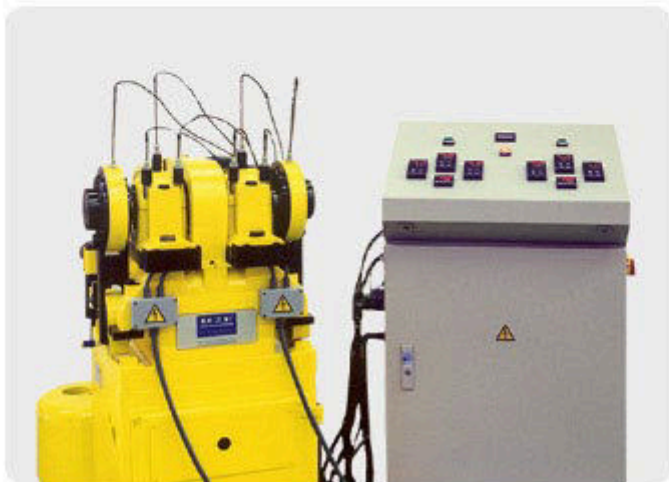
Машина R2F для испытания пластичной смазки
