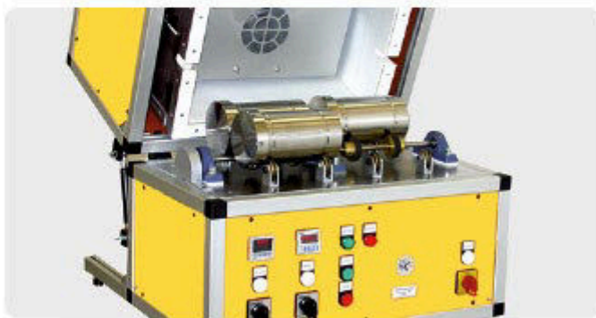
Машина для испытания стабильности при перекачивании
