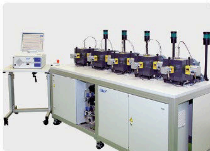
Машина ROF+ для испытания пластичной смазки
