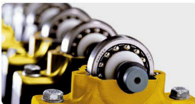
Машина Етсог для испытания пластичной смазки
