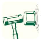
Втулку монтировать легкими ударами по монтажному колпачку до ее установки на необходимом расстоянии. Снять монтажный инструмент.
