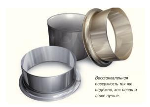
Speedi-Sleeve – это простой и экономичный способ создания новой рабочей поверхности уплотнения на валах с поврежденной поверхностью, на изношенных валах и даже на новых валах.
