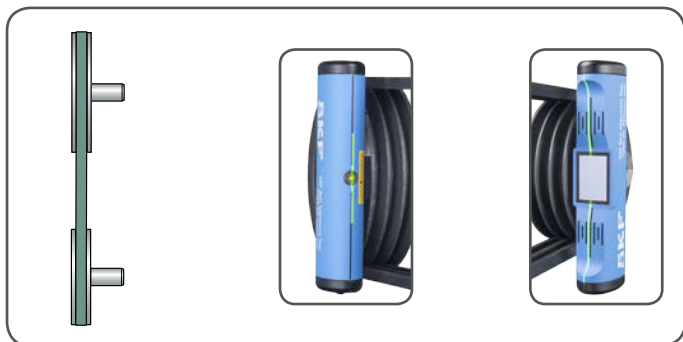
Abbildung 9 Perfekt ausgerichtete Riemenscheiben
