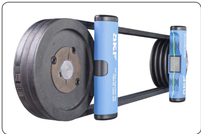
Imagen 4 Unidades montadas en poleas
