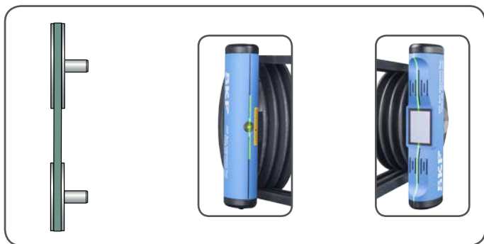
Рисунок 9 Соосность шкивов после правильно выполненной выверки
