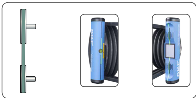
Figure 9 Poulies parfaitement alignées
