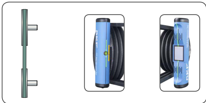
Figura 9 Polias perfeitamente alinhadas
