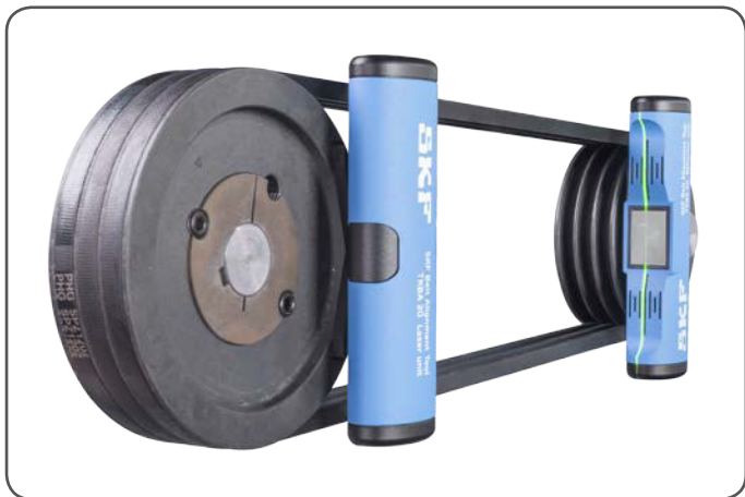
Figure 4 Unités montées sur poulies
