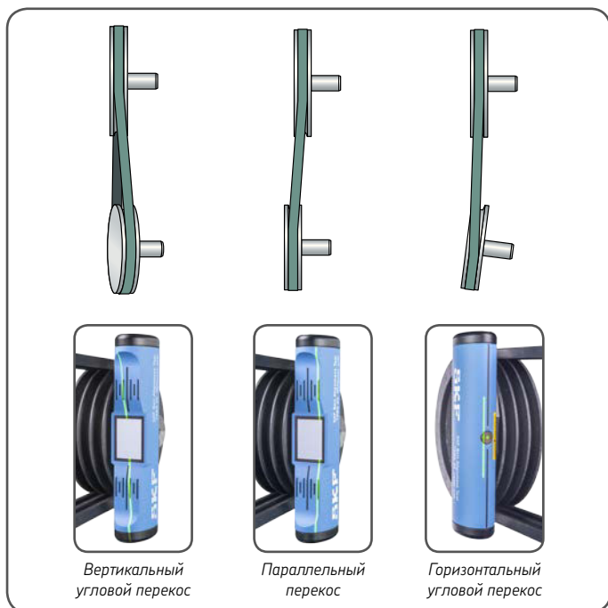
Рисунок 5 Определение типа перекося
