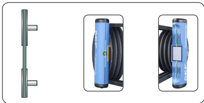
图 9 皮带轮已完美对中
