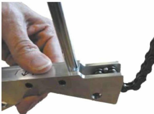
Рисунок 3-9. Прикрепление цепи в сборе к связному болту
