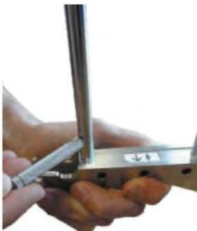
Рисунок 3-6. Затягивание штыря с помощью торцевого ключа
