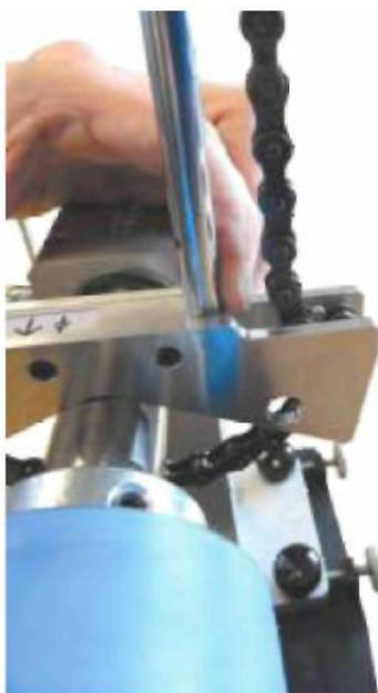
Рисунок 3-11. Затягивание цепи на связном болте
