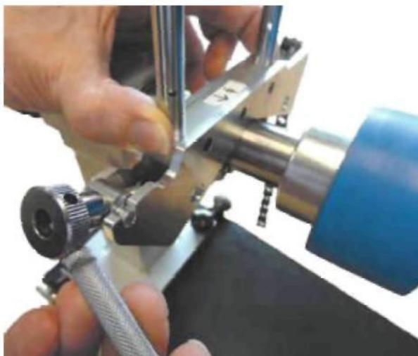
Рисунок 3-12. Закрепление кронштейна на валу
