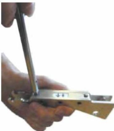
Рисунок 3-5. Ввёртывание длинного штыря в кронштейн
