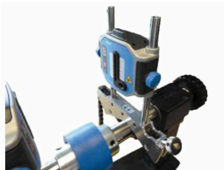
Рисунок 3-14. Измерительный блок, закреплённый на клиновидном кронштейне
