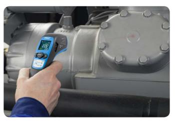
При использовании бесконтактного режима измерений термометр воспринимает тепловую энергию, излучаемую объектом, с помощью инфракрасного детектора. При наведении на объект, инфракрасный датчик собирает энергию, производя сигнал, который микропроцессор транслирует как значение на экране. При нажатом триггере инфракрасный датчик измеряет температуру объекта непрерывно. Это обеспечивает быстрое и
