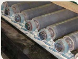
Перегрев подшипника конвейера
