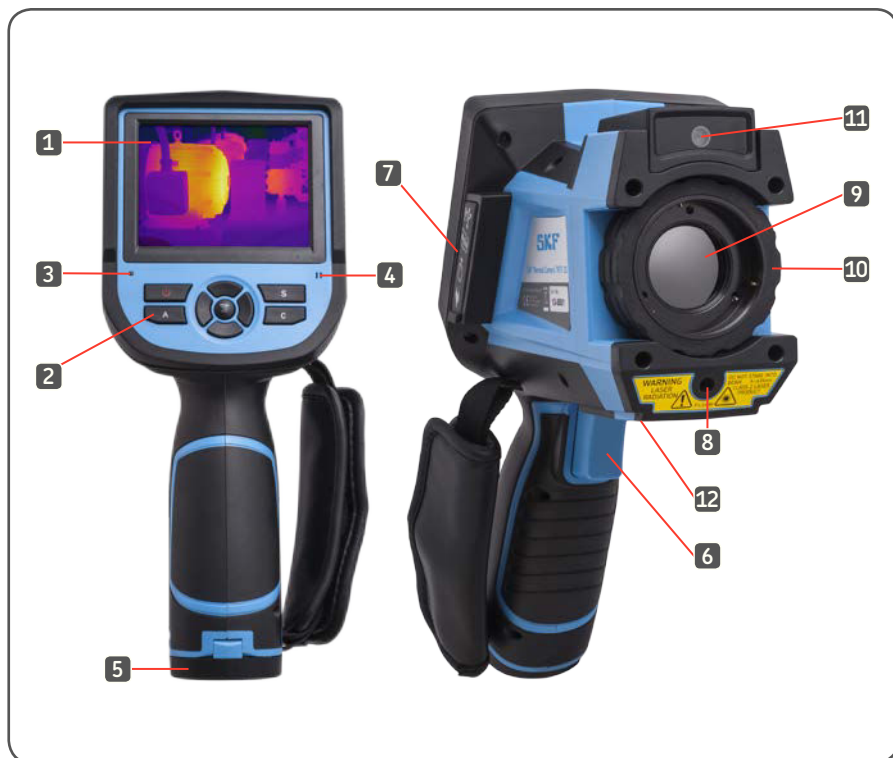
Рисунок 2 Описание тепловизора
