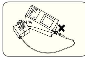
B Collegare il morsetto del riscaldatore alla scatola comandi. Durante il funzionamento **non** collegare o scollegare mai il morsetto del riscaldatore
